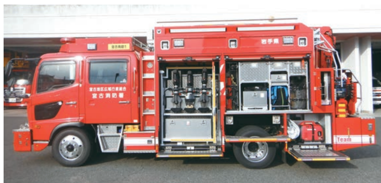
新たにバッテリー式の油圧救助器具を採用。交通事故等での活動に使用します。
