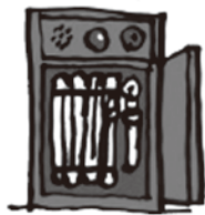
屋内消火栓設備
