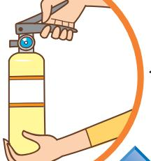
3 片方の手で住宅用消火器の底を持ち、もう一方の手でレバーを力強くギュッと握ります。
